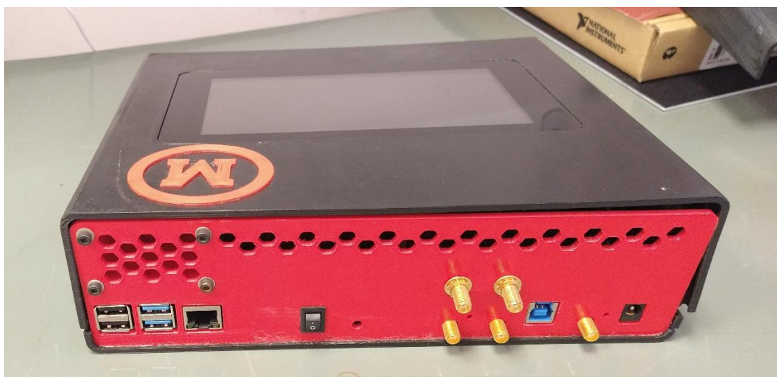
Figura 96 – Detalhe das conexões traseiras para antena, USB, ethernet e outras (Autoria própria).
