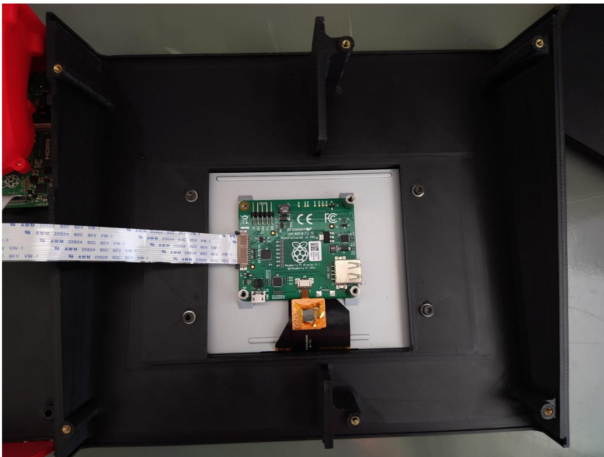
Figura 95 – Conexão com o display LCD (Autoria própria).
