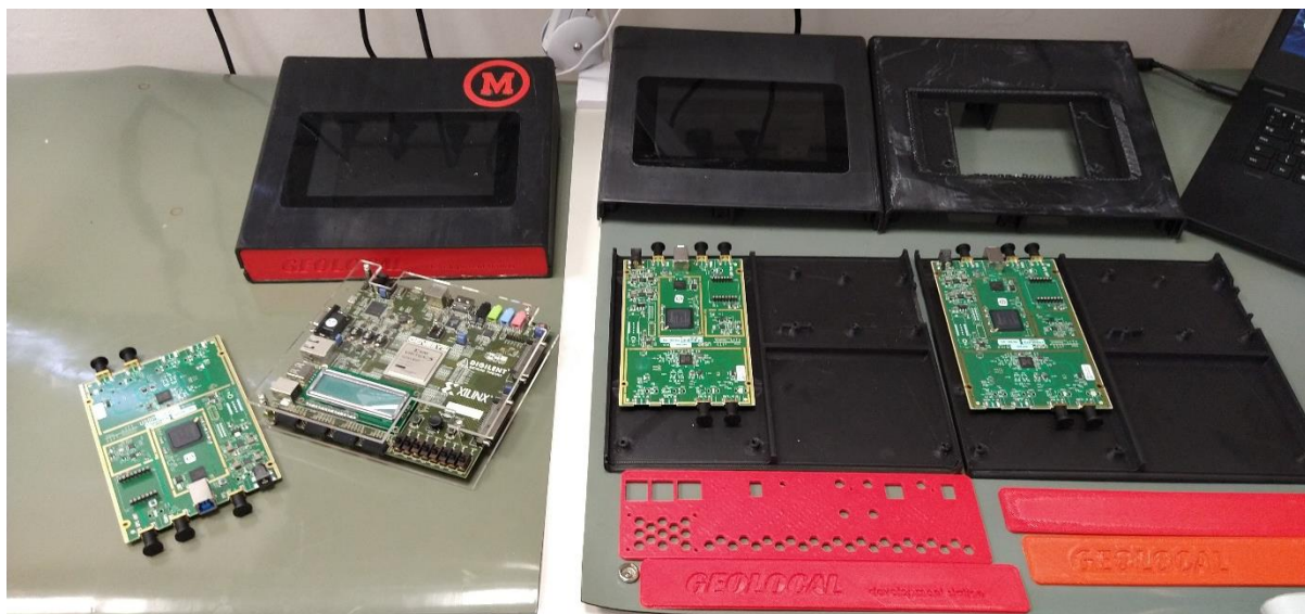
Figura 91 – Protótipos em montagem (Autoria própria).
