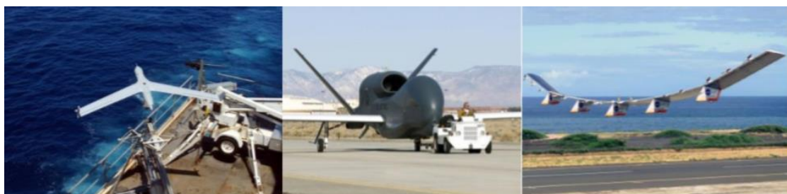
Figura 21 – Exemplos de RPAs, da esquerda para a direita: ScanEagle da Insitu-Boeing; GlobalHawk, da Northrop Grumman; e o protótipo Helios da AeroVironment (HOBBS, 2016, p. 1).
