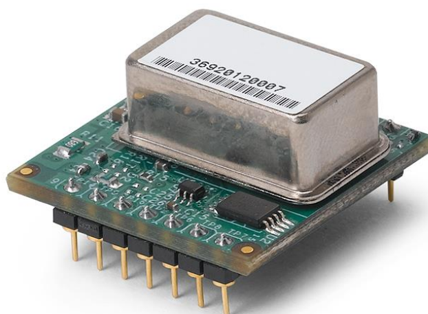
Figura 80 - GPSDO para o USRP B200 da Ettus Research (ETTUS, 2020).
