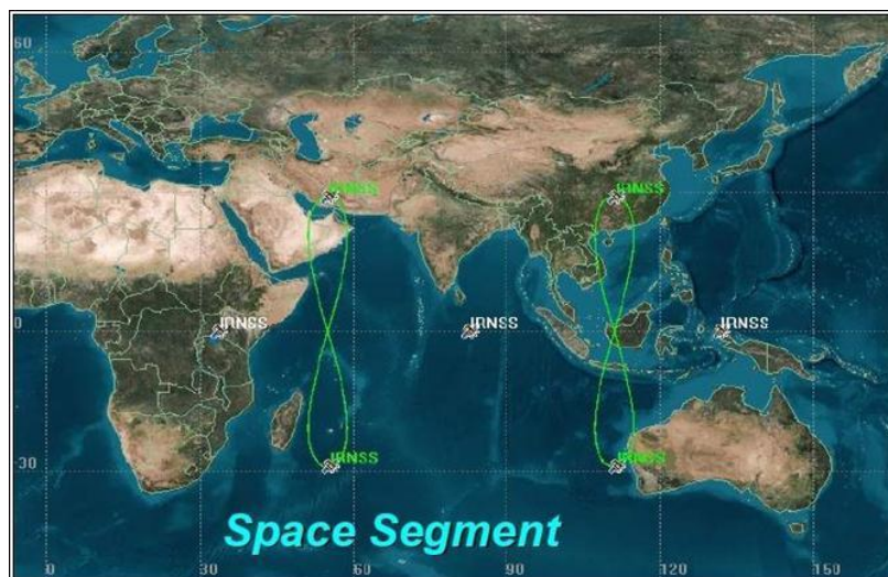
Figura 5 – Sistema indiano NAVIC, com as projeções dos 3 satélites geoestacionários e 4 geossíncronos (ISRO, 2018).
