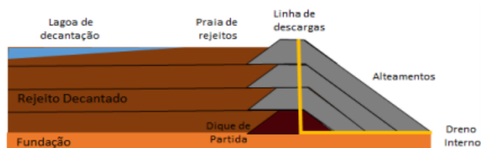
Figura 5 – Método de Alçamento por linha de centro
