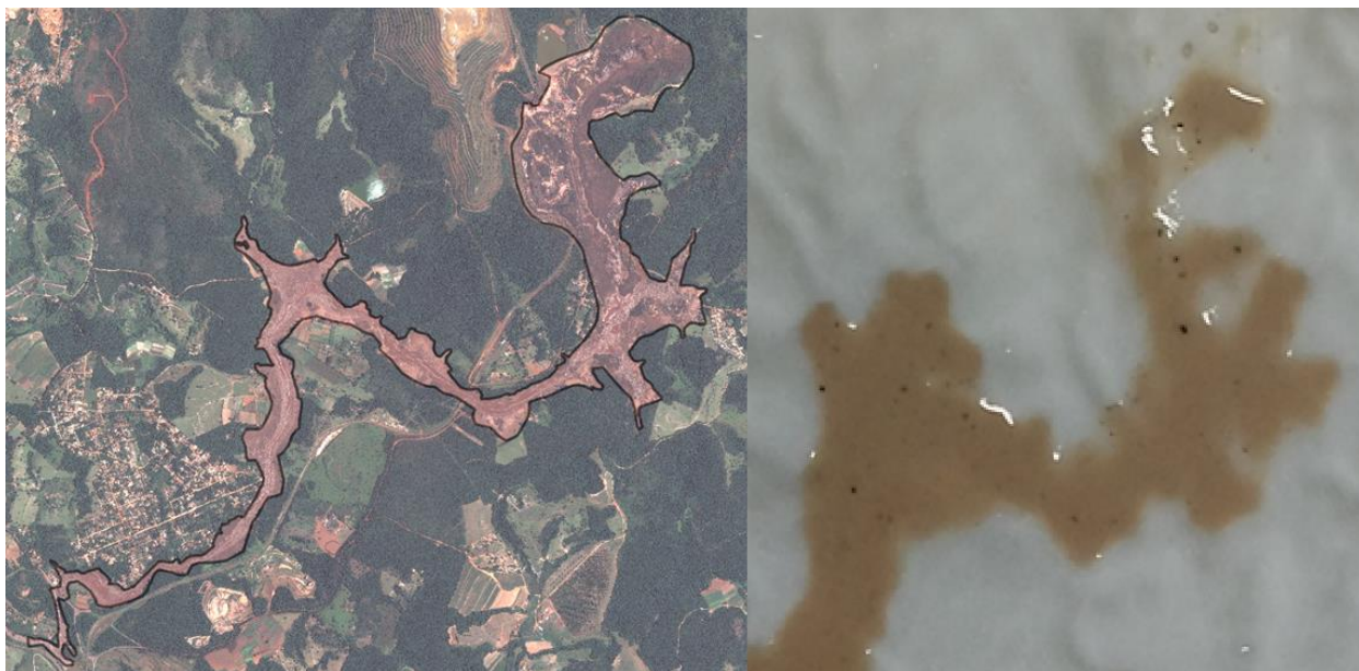
Figura 14- Comparação área de inundação real com a obtida no modelo 3D.
