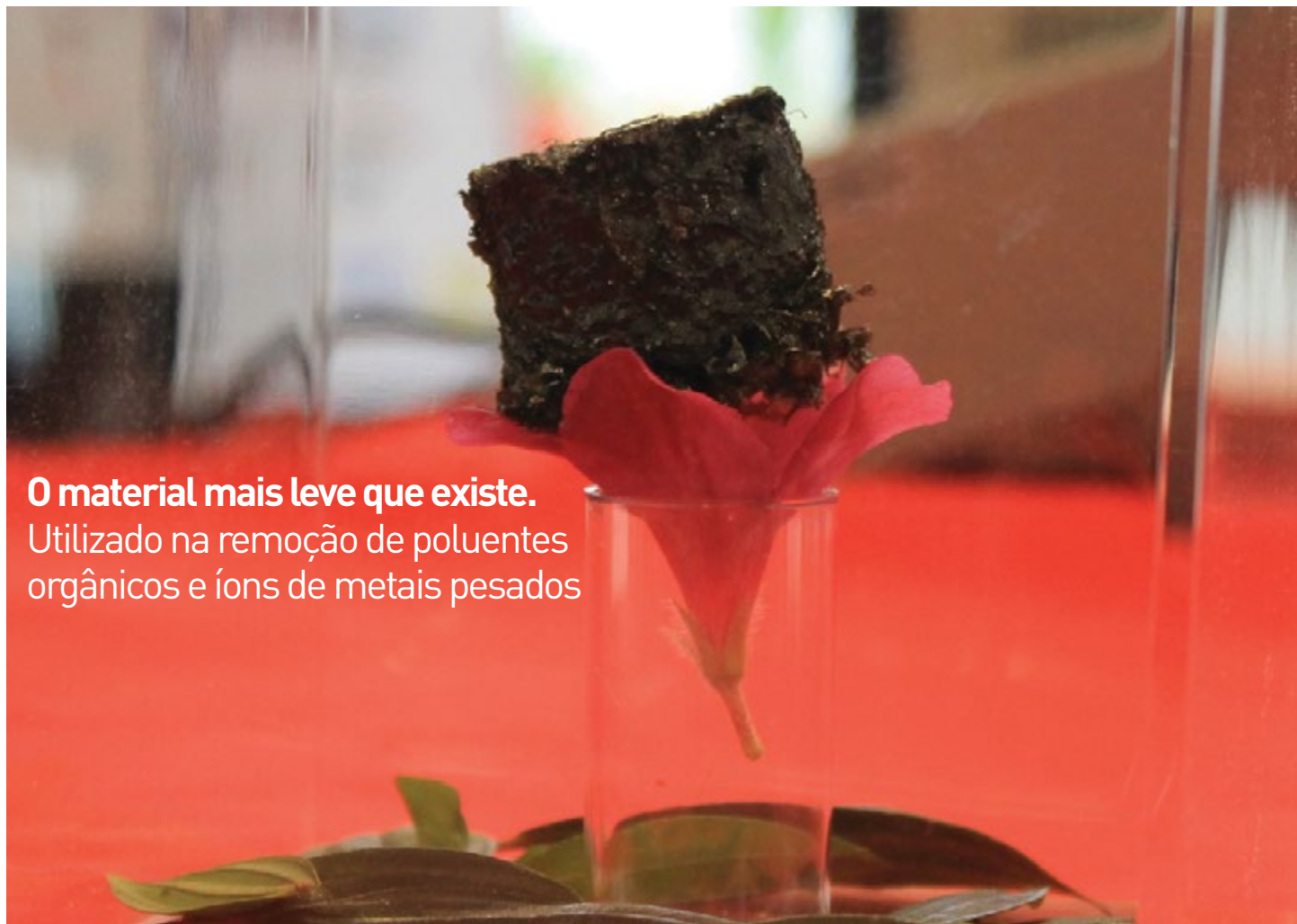
Aerogel de grafeno produzido no MackGraphe
