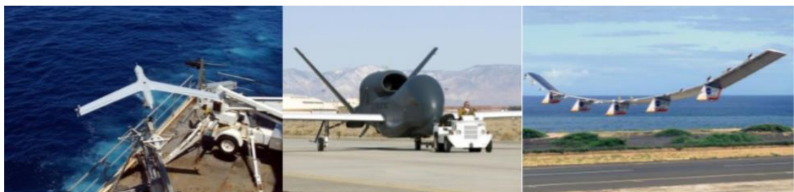
Figura 22: Exemplos de RPAs, da esquerda para a direita: ScanEagle da Insitu-Boeing; GlobalHawk, da Northrop Grumman; e o protótipo Helios da AeroVironment (HOBBS, 2016, p. 1).
